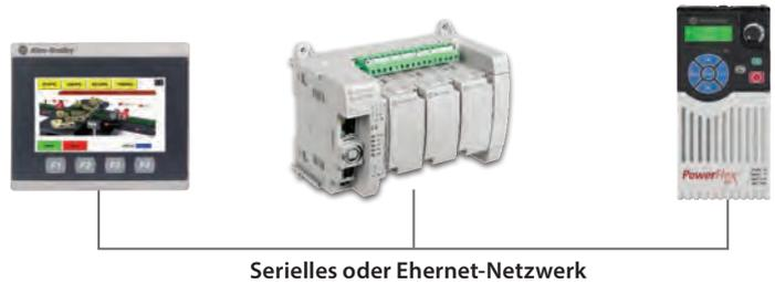
Optimiert für die Verwendung mit Micro800- und MicroLogix-Steuerungen.
